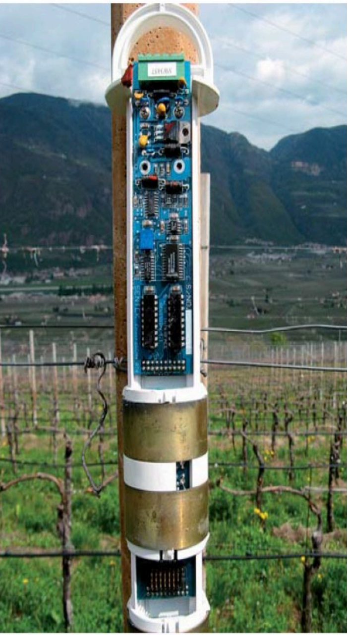
Interno di una sonda EnviroSCAN.
